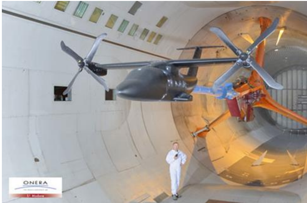
Рис.2.1. Випробування європейського проекту поворотного гвинта (Nicetrip) у великій аеродинамічній трубі S1MA компанії ONERA [55]
