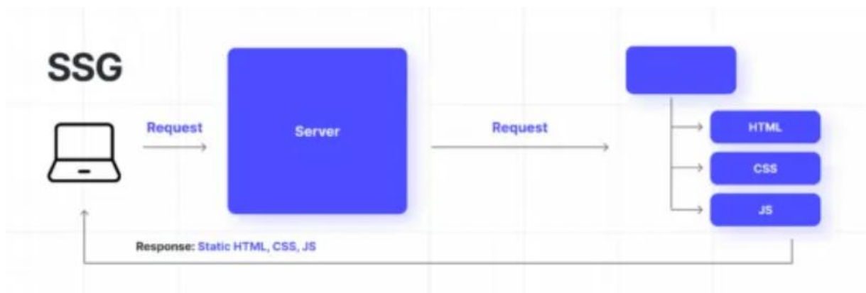
Рис. 2.3. Метод роботи SSG(Server-side Generating)
