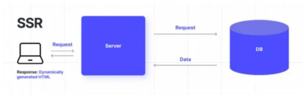
Рис. 2.2. Метод роботи SSR(Server Side Rendering)
