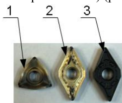
Рис. 1. Внешний вид пластин: 1 – из ВК8, 2 – СандвикКоромант (Н13) и покрытие 0,2 \text{ HfN} + 0,8 \text{ ZrN} , 3 – СандвикКоромант с двухслойным покрытием \text{Al}_2\text{O}_3 + 0,2 \text{ HfN} + 0,8 \text{ ZrN}
