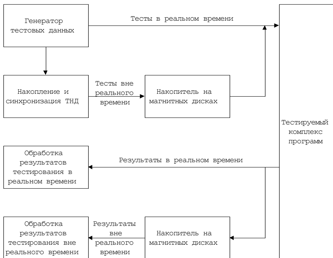
Рисунок 1. Функциональная организация процесса тестирования при помощи имитационно-моделирующего стенда
