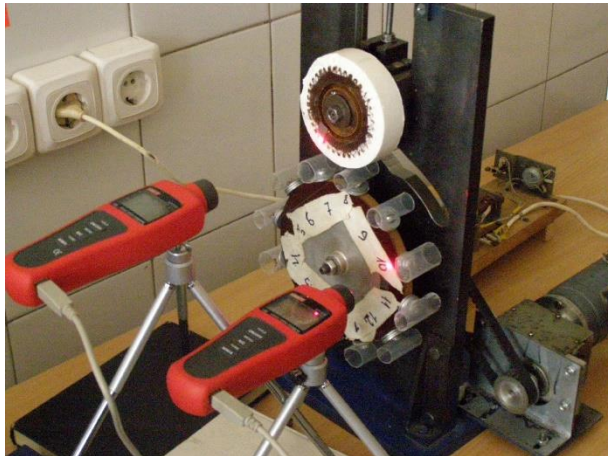
Рис. 1. Зовнішній вигляд експериментального стенду, що імітує друкарський контакт РТДА
