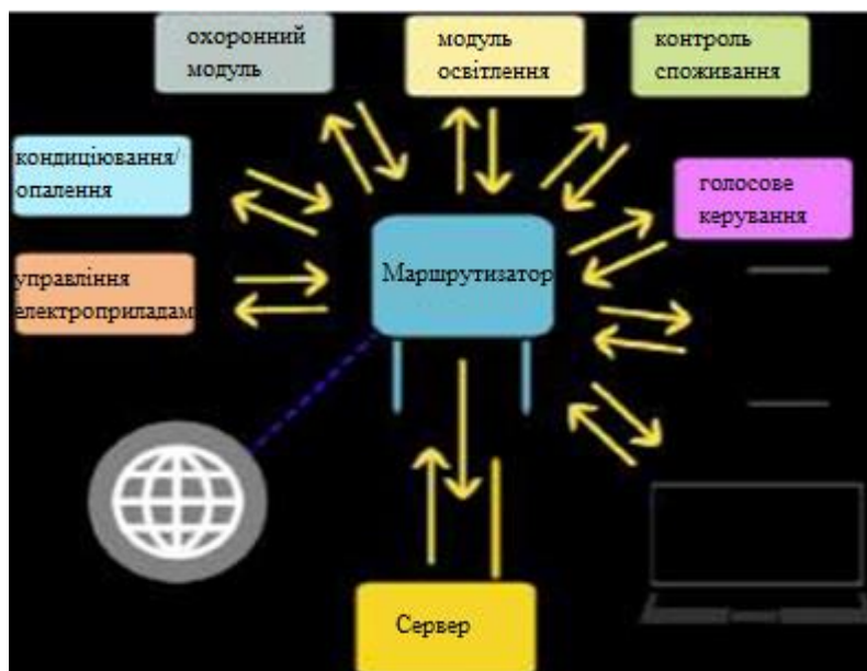
Рис. 1.2 Принцип побудови системи «розумний дім» з бездротовим маршрутизатором або модемом
