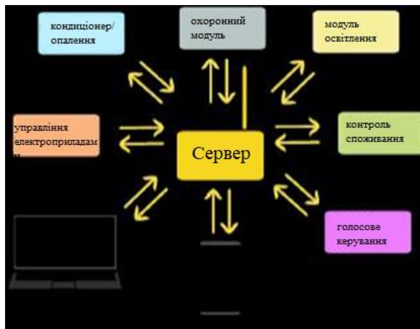
Рис. 1.3 Принцип побудови системи «розумний дім» із сервером у режимі програмної точки доступу
