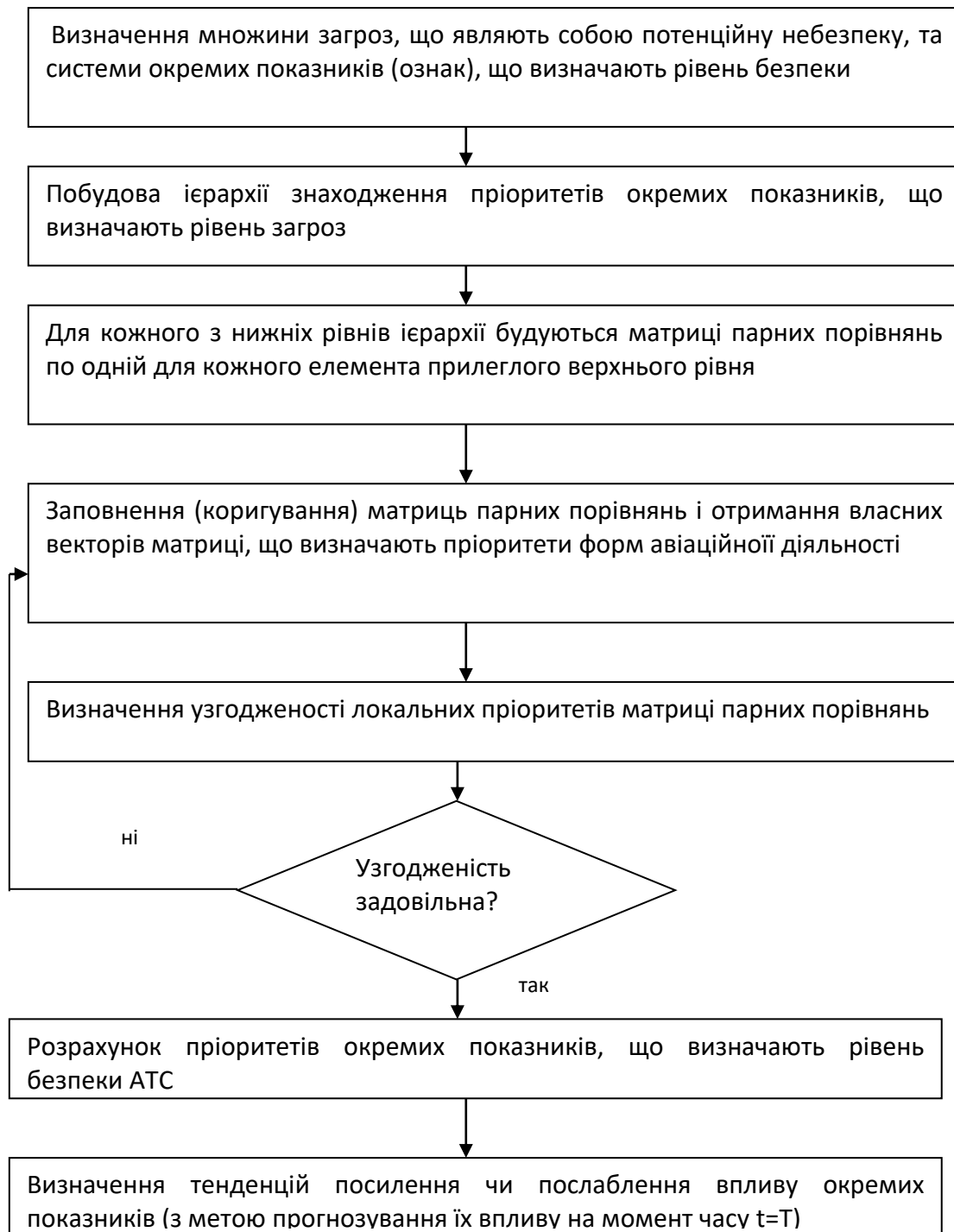
Рисунок 2.3 – Блок-схема алгоритму визначення пріоритетів окремих показників, що характеризують рівень АТС
