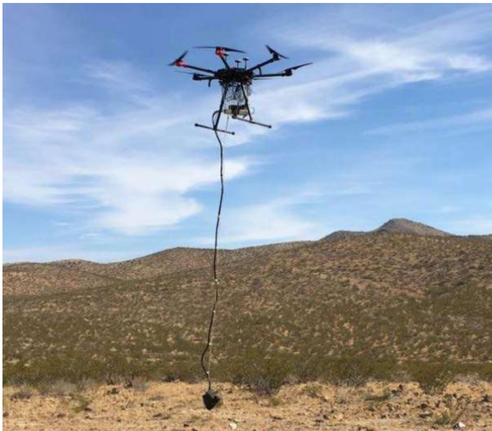
Рис. 3.2 Магніометр, встановлений на «маятникову систему» БПЛА
