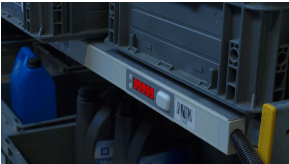
Рисунок 3.11 – Система Pick by Light
