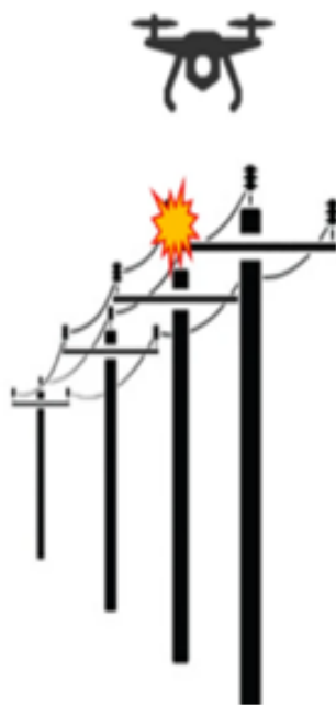
Рисунок 1.7. БПЛА здійснює перевірку перевірці ліній електропередач
