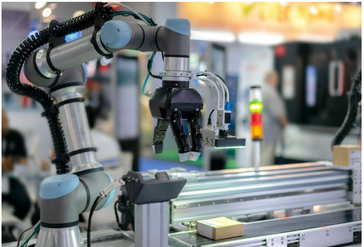
Рис. 1.2.1. Приклад механічного захвату
