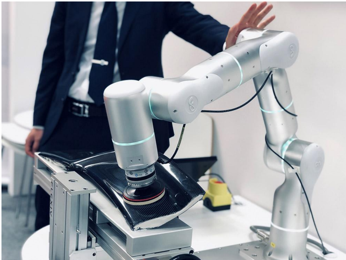
Рис. 1.3.2. Адаптивний робот другого покоління з присмоктувачами від Flexiv Rizon
