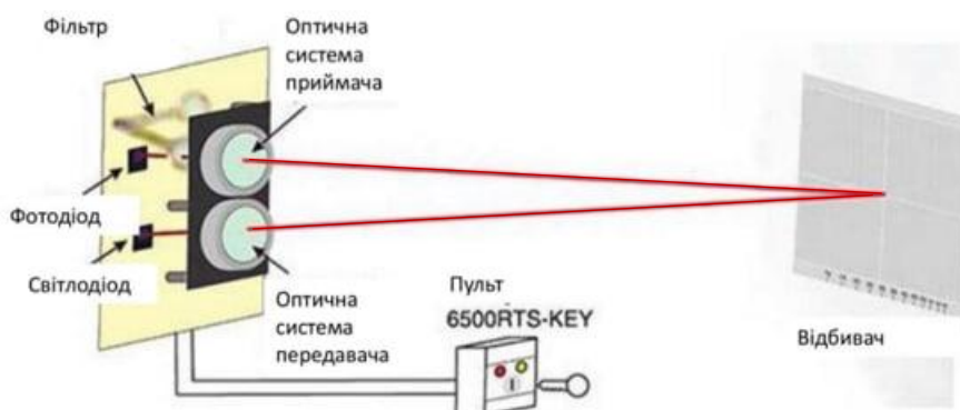
Рис.1.3 Структурна схема застосування радіохвильового датчика
