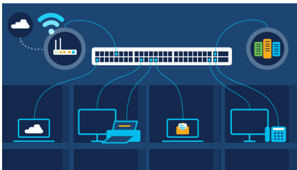
Рис. 1.2. Стандартна схема роботи комутатора
