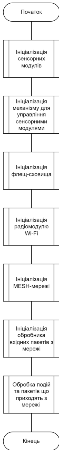
Рис. 3.8. Схема алгоритму роботи прошивки мікроконтролера
