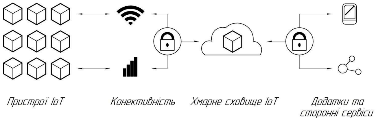
Рис. 1.10. Схематичне зображення обміну даними в системах IoT
