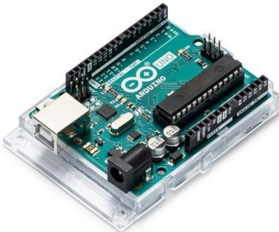
Рис. 2.4. Мікроконтролер Arduino Uno Rev3
