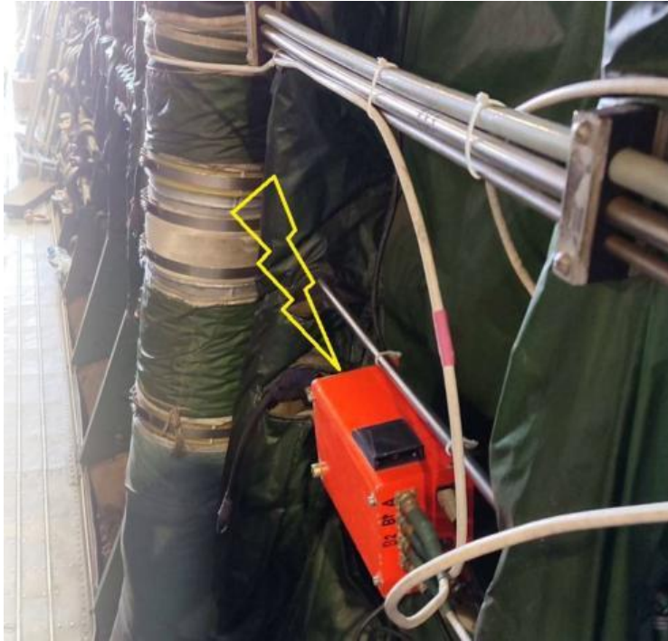
Рис. 9 Встановлення комп'ютера IP5, збір даних, конвертація, запис файлу на SD-карту * . txt і передати дані через Ethernet на ноутбук.
