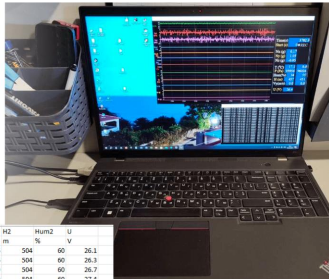
Рис. 9 Встановлення комп'ютера IP5, збір даних, конвертація, запис файлу на SD-карту * . txt і передати дані через Ethernet на ноутбук.
