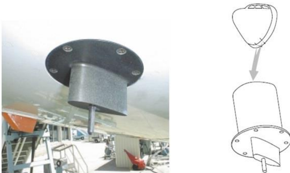
Рис. 2.10. Розташування детекторів обледеніння на фюзеляжі літака
