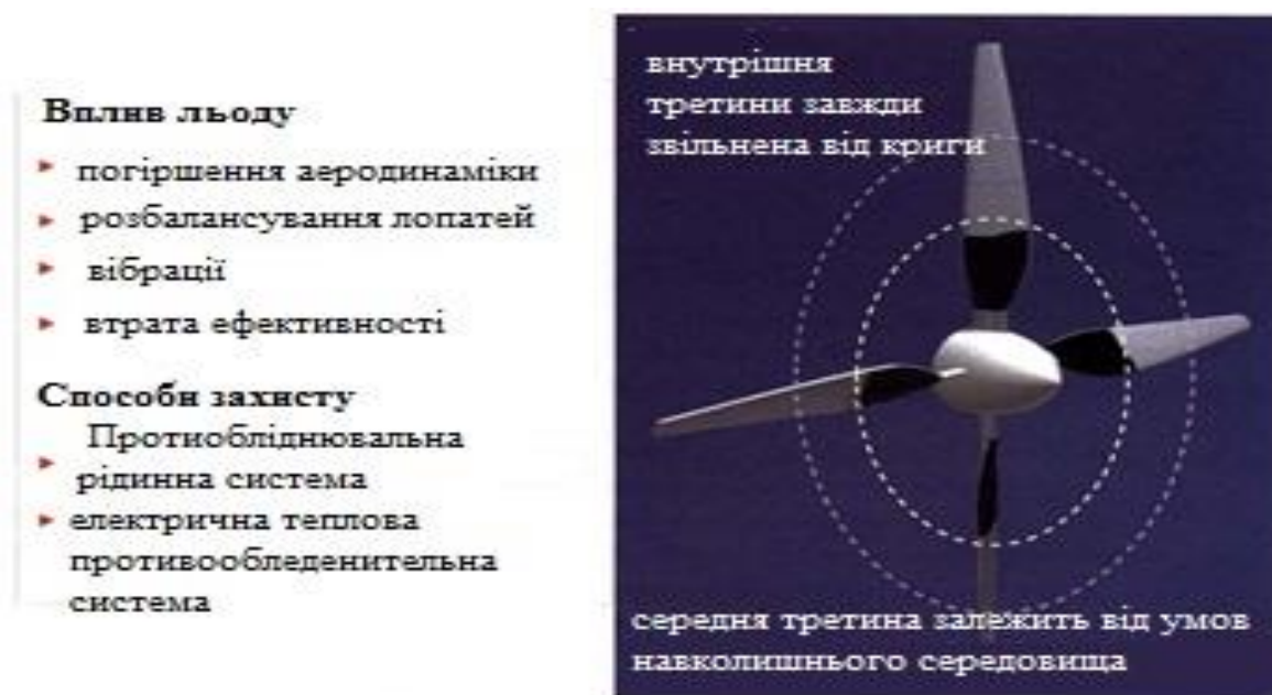
Рис. 1.18. Протиобліднювальні системи гвинта
