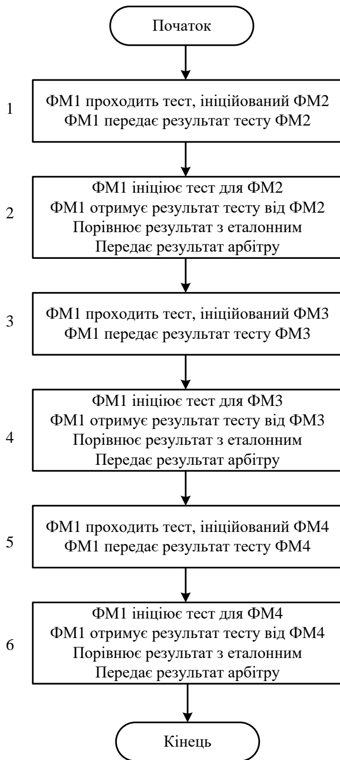
Рис. 2.10. Алгоритм роботи функціонального модуля у режимі тестового контролю (приклад тестування одного ФМ)
