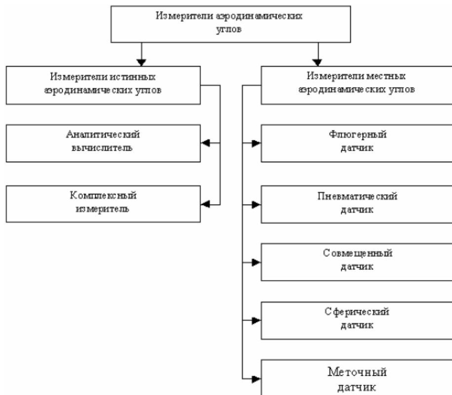
Рис. 2.7 Класифікація датчиків аеродинамічних кутів літального апарату
