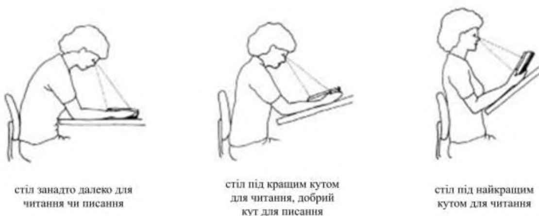
Рис. 2.1. Взаємозв'язок форми робочого місця та кута читання
