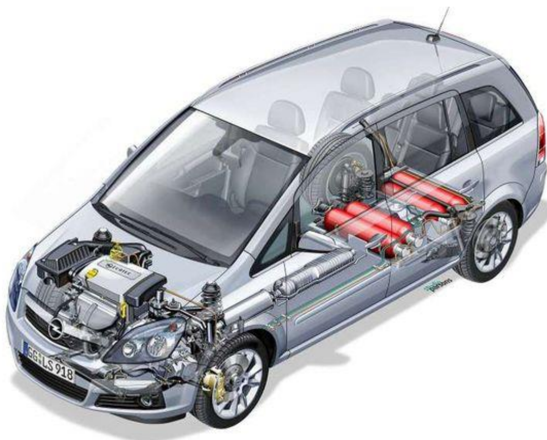
Рисунок 3.6 – Переобладнання автомобілів на CNG [65]
