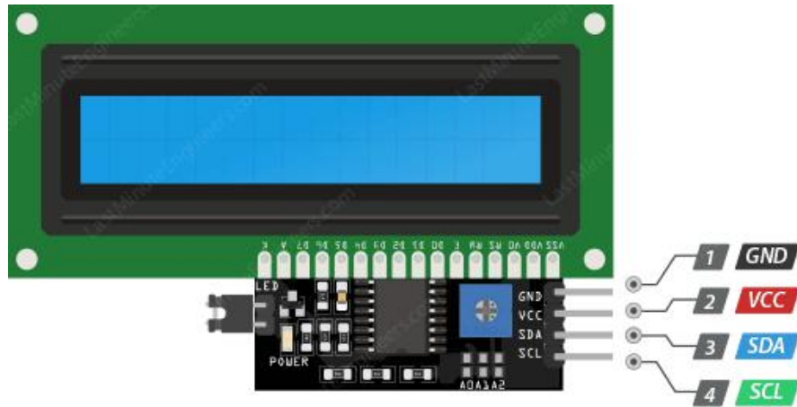
Рис. 3.11 Розпіновка виходів LCD 2004 I2C
