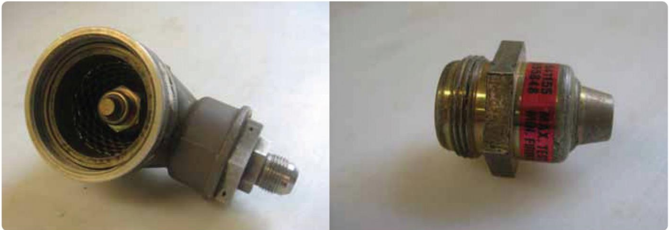
Рис. 2.3. Нагнітальний клапан (ліворуч) і картридж або піропатрон (праворуч)
