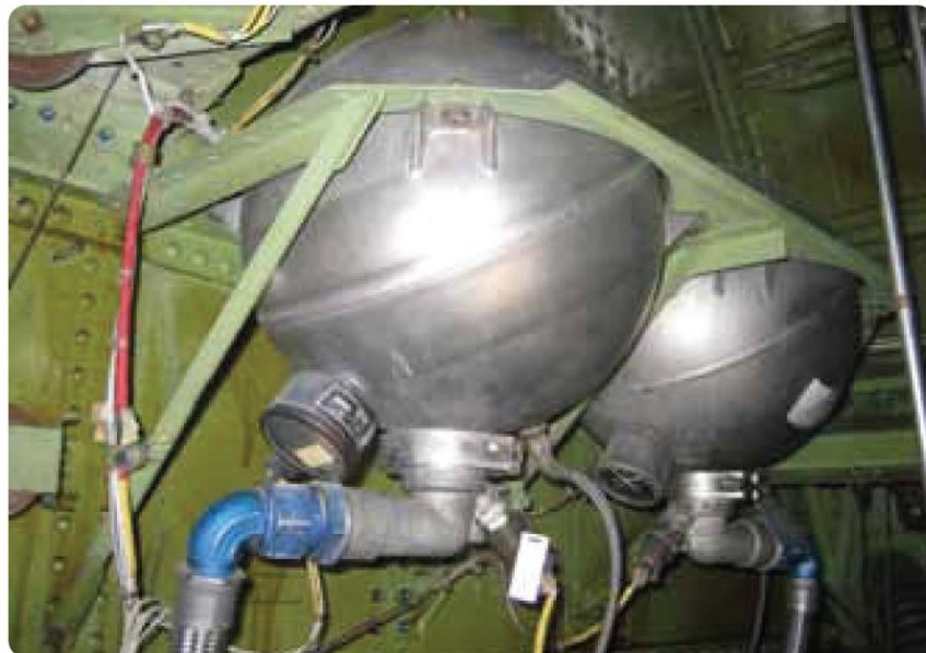
Рис. 2.1. Вбудовані непереносні контейнери для вогнегасників (пляшки HRD) на літаку
