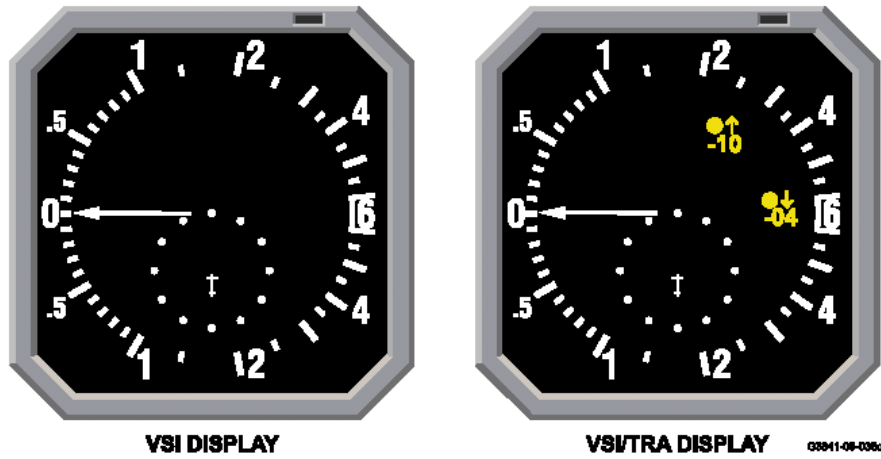
Рис. 1.4. Індикація системи TCAS на дисплеї VSI/TRA
