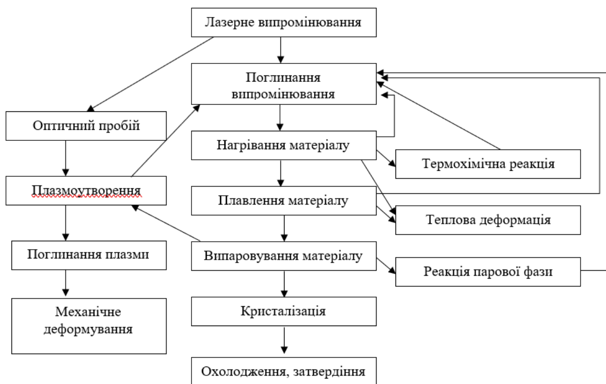
Рис. 3.1. Зв'язок фізичних процесів при впливі лазерного випромінювання на матеріали.
