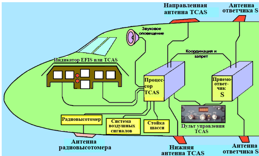
Рис. 1.6. Схема системи TCAS.
