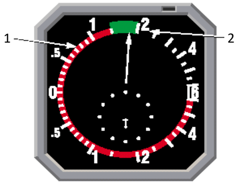
Рис. 1.5. Відображення рекомендації на дисплеї VSI/TRA :
