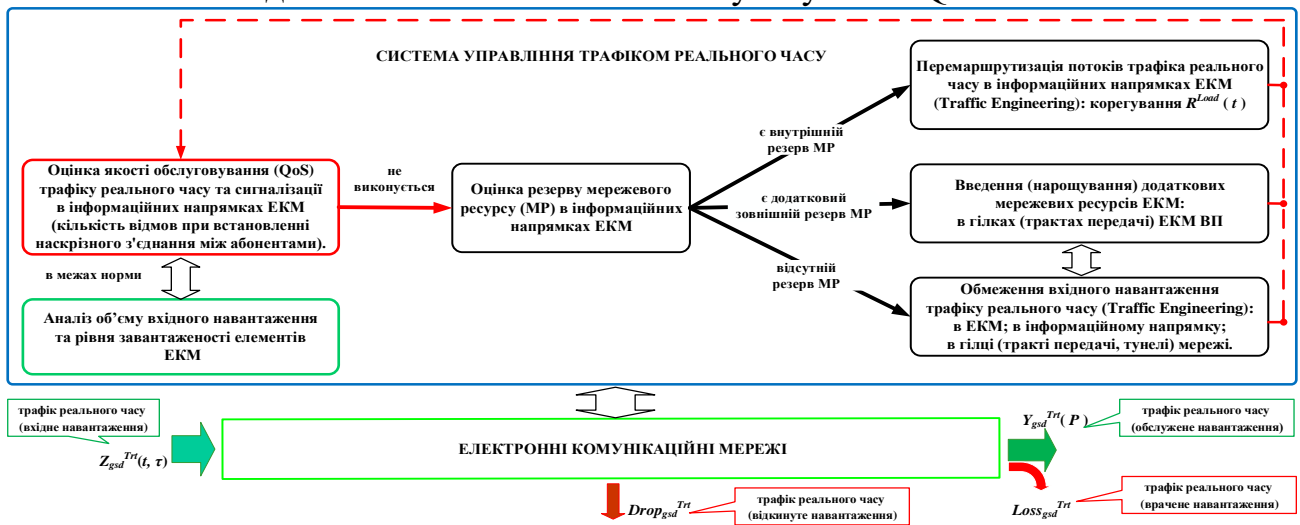
Рис. 6. Узагальнена схема функціонування СУ трафіком реального часу в процесі забезпечення QoS трафіка реального часу
