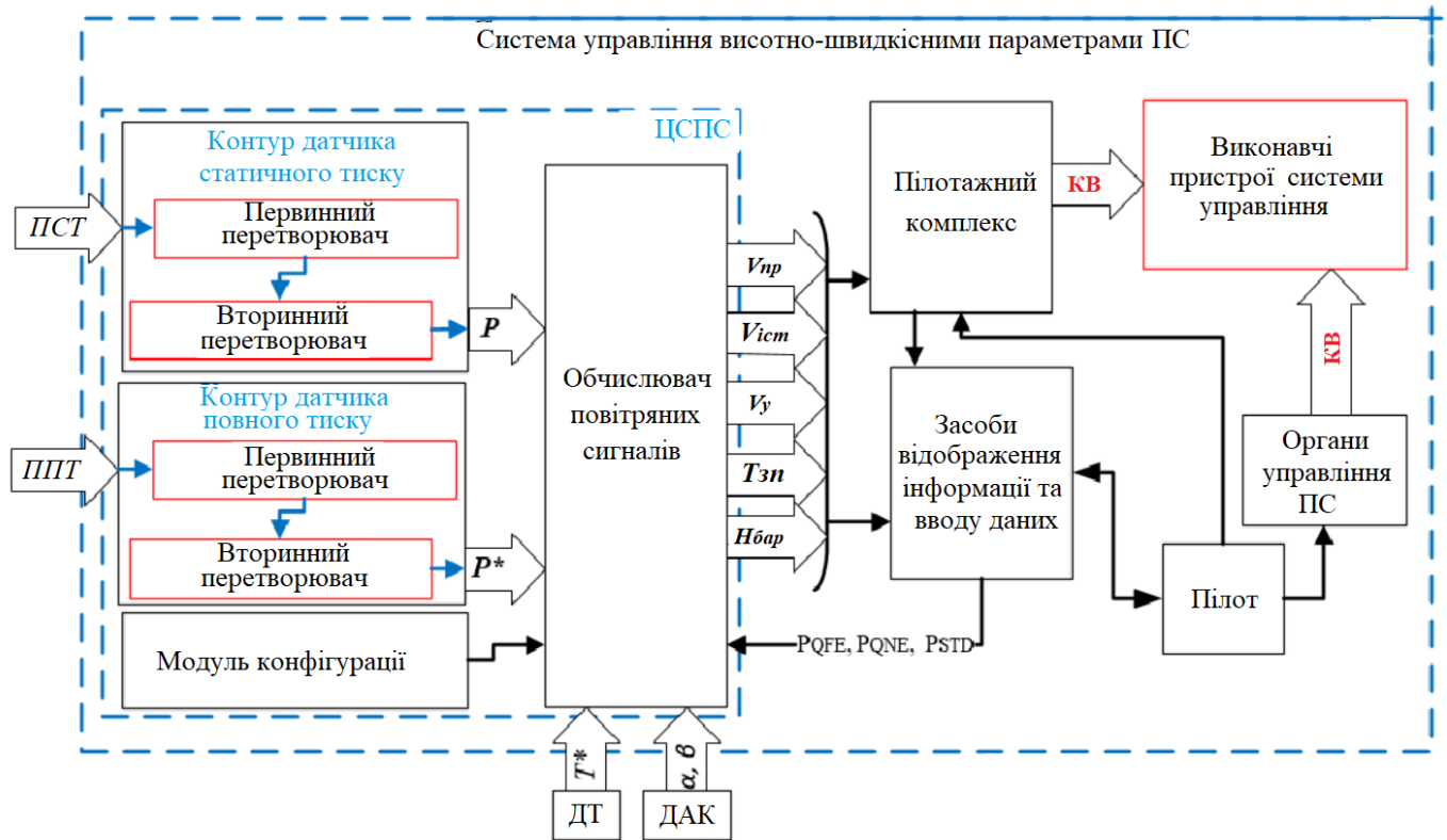
Рис. 1.1. Функціональна схема системи управління висотно-швидкісними параметрами ПС: P - статичний тиск, P^* - повний тиск, T^* - температура загальмованого потоку; \alpha, \beta - аеродинамічні кути, V_{np} - приладова швидкість, V_{icm} - істинна швидкість, V_y - вертикальна швидкість, H_{бар} - барометрична висота, ПСТ - приймач статичного тиску, ППТ - приймач повного тиску, ДТ - датчик температури, ДАК - датчик аеродинамічних кутів, ЦСПС - цифрова система повітряних сигналів, КВ - керуючий вплив
