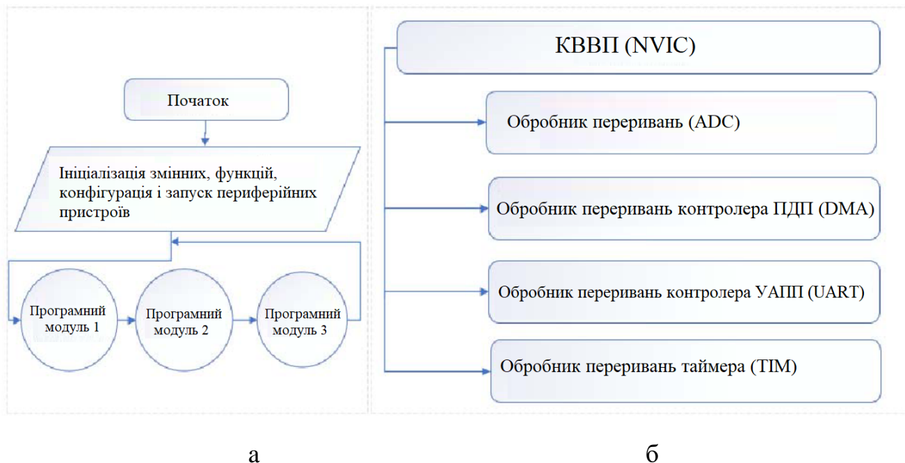
Рис. 3.14. Принцип реалізації програмного забезпечення мікроконтролера STM32F4: а – логіка роботи АЛУ, б – активні переривання
