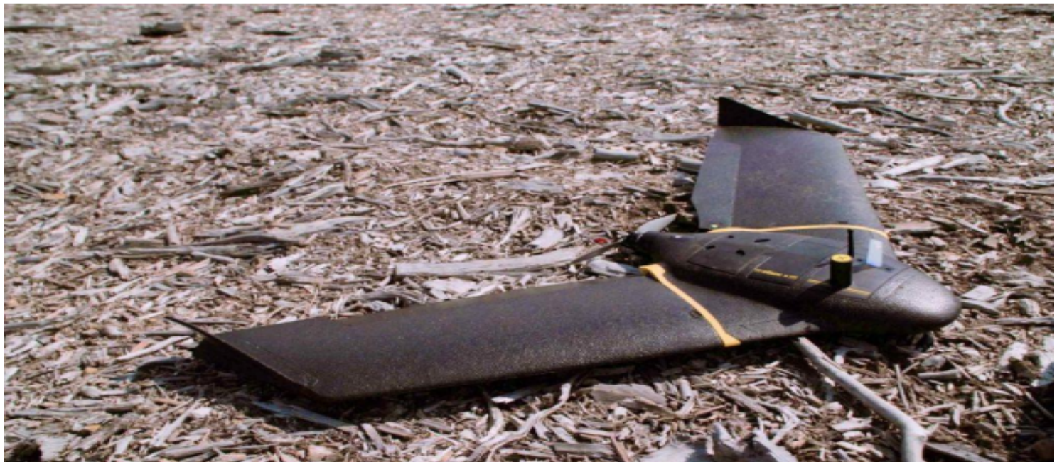
Рис. 1.4. Зовнішній вигляд безпілотної літальні апарату з нерухомими крилами.
