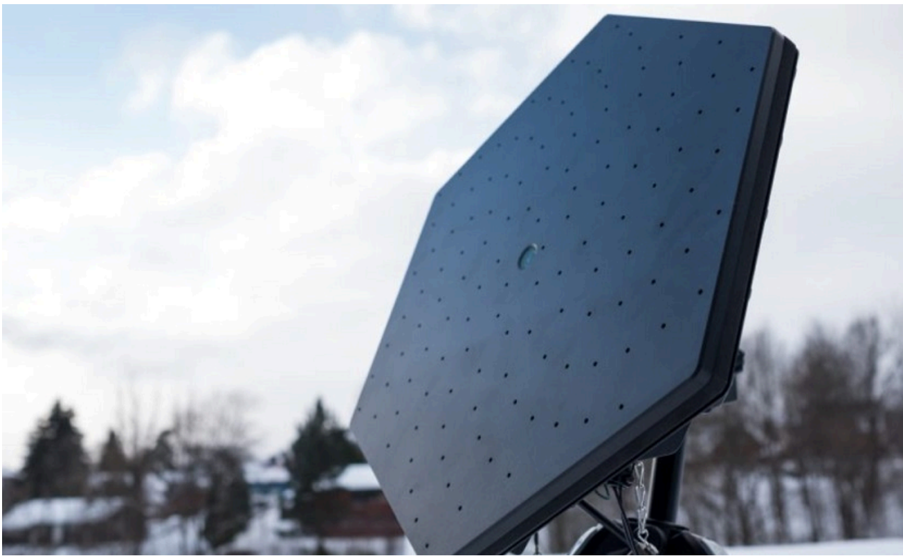
Рис. 2.3- Акутична система виявленя БПС
