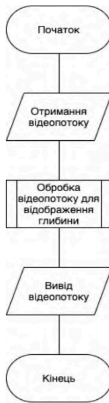
рис. 5.5 Алгоритм роботи модуля комп'ютерного зору
