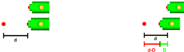
Рис. 1.2 Пояснення шляхом заміни хвиль на окремі імпульси і частоти коливання на частоту фіксації одержання імпульсів (випадок 1 – рух назустріч)
