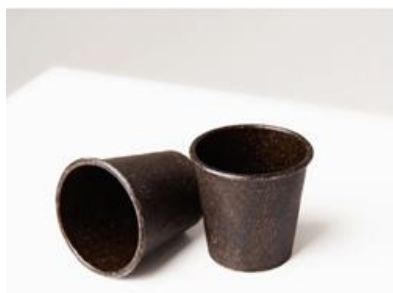
Рисунок 1.9 - Лабораторні прототипи одноразового біорозкладного посуду rekava з кавової гущі
