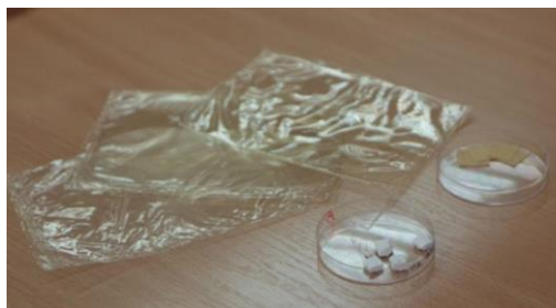
Рисунок. 1.8 - Біорозкладна плівка з хітозану
