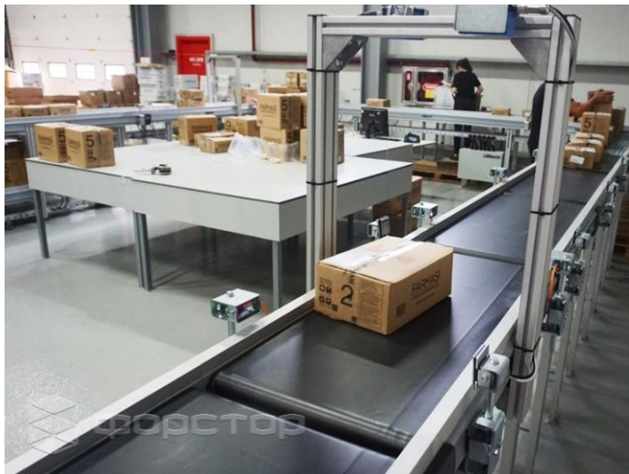
Рис. 1.21. Система вимірювання габаритів та ваги
