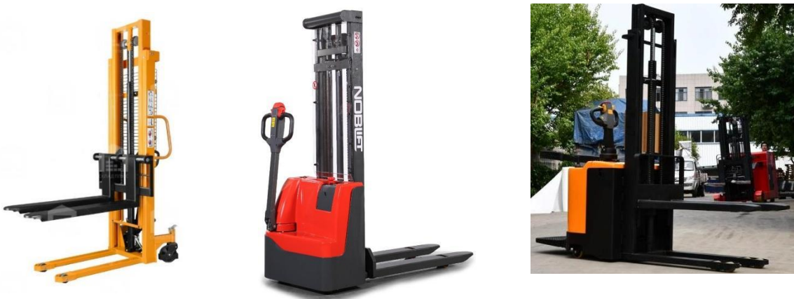
Рис. 1.11. а) ручний (гідравлічний) штабелер; б) електричний штабелер; в) самохідний штабелер;
