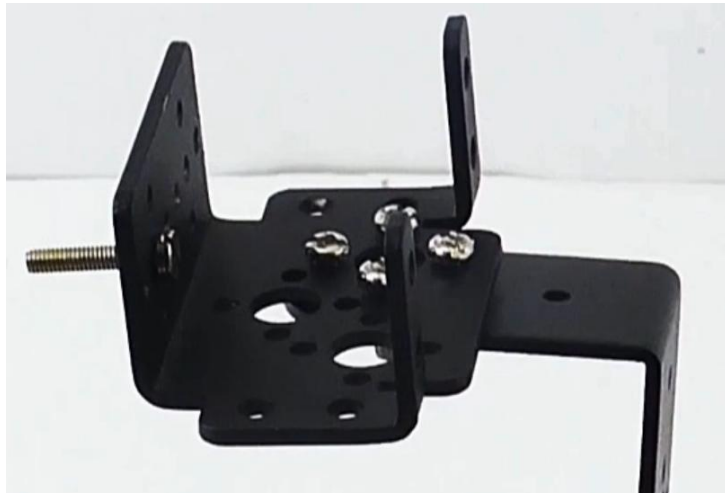
Рис. 3.11 Додавання допоміжного гвинта
