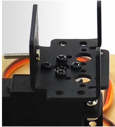
Рис. 3.6 Гвинт для кріплення ліктя
