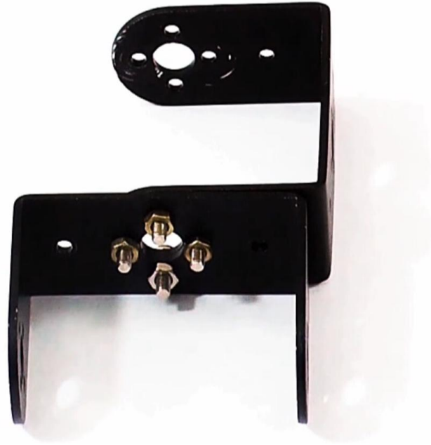
Рис. 3.8 Конструкція ланки для ліктя
