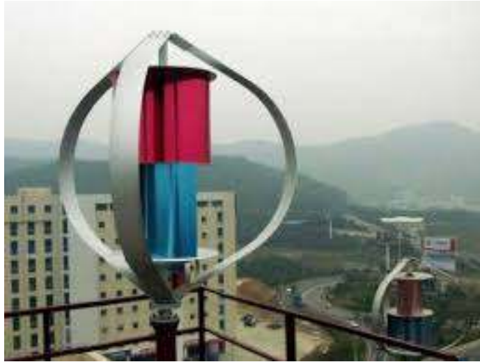
Рис.1.2. Гібридна вітроенергетична установка з вертикальною віссю обертання
