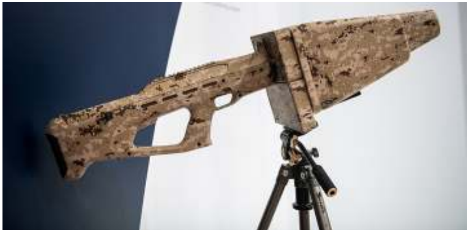
Рис. 2.3 Комплекс протидії безпілотним літальним апаратам "Піщаль-Про"
