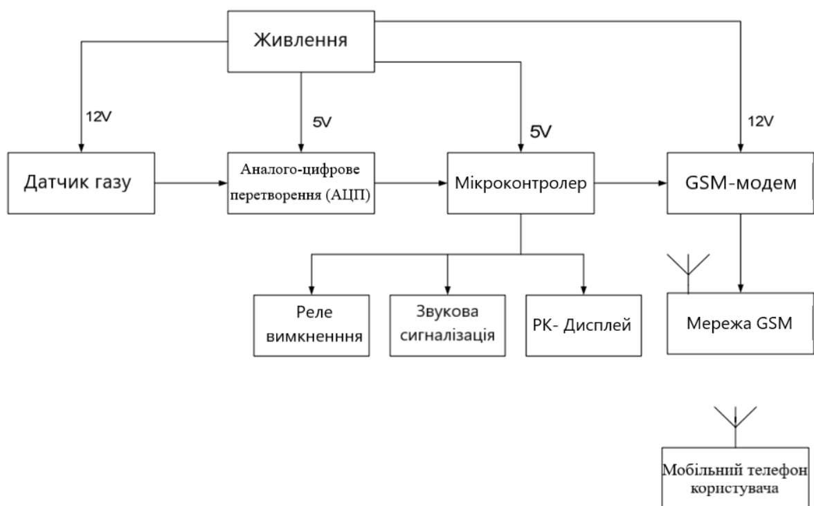
Рис. 2 Структурна схема системи виявлення витоків газу
