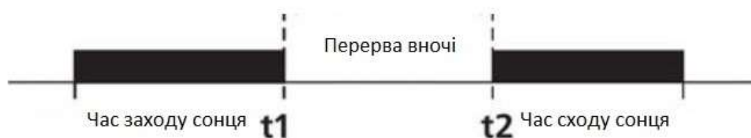
Рисунок 2.7 - Діаграма роботи реле РСЗ-527
