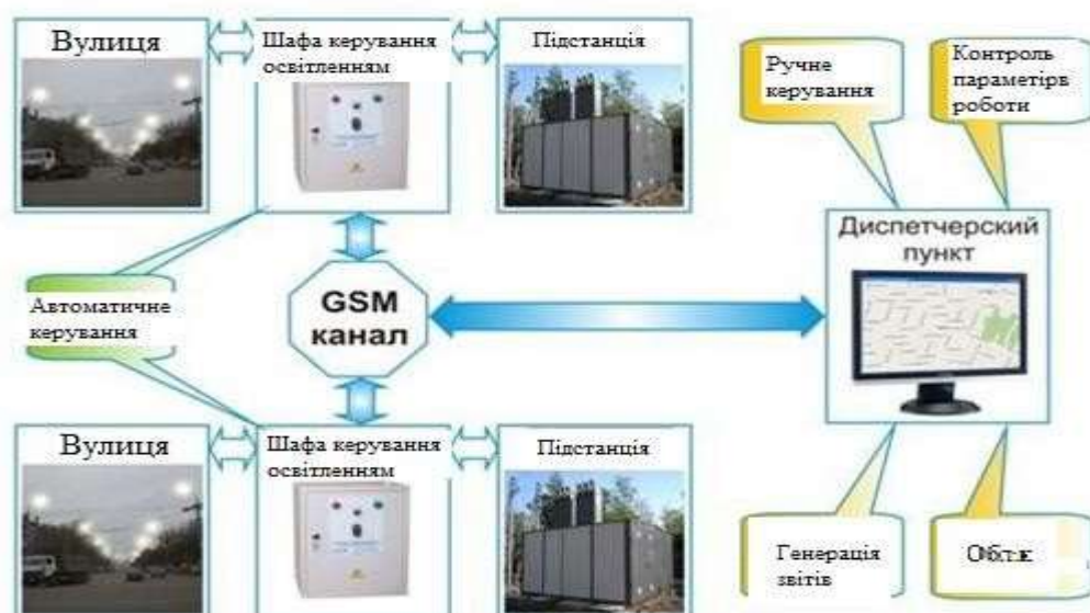
Рисунок 4.1 - Складові елементи в системі управління зовнішнім (вуличним) освітленням.
