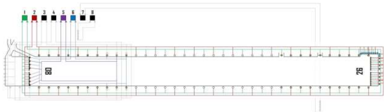
Рис.2.4. Схема електропостачання аеродромних вогнів ЗПС у режимі „Літ” МК-261*
