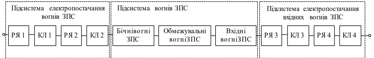
Рис. 4.6. Надійнісно-функціональна схема електропостачання підсистеми вогнів ЗПС з електропостачанням вхідних вогнів ЗПС по двох окремих КЛ.
