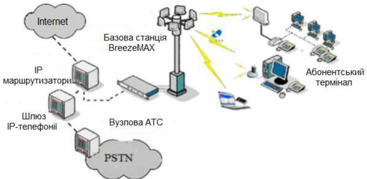
Рис. 2.1. Базова структура мережі на основі BreezMAX
