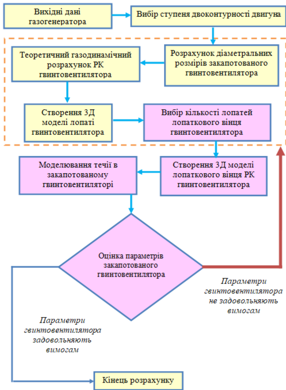
Рис. 3.1. Алгоритм удосконаленої методики проектування закапотованого гвинтовентилятора для турбореактивного двоконтурного двигуна з надвисоким ступенем двоконтурності
