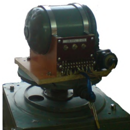
Рис. 4.5 Рухома платформа з датчиками зворотного зв'язку
