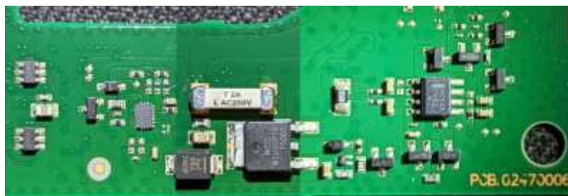
Рис. 2.18 Контролер Dishy PoE
