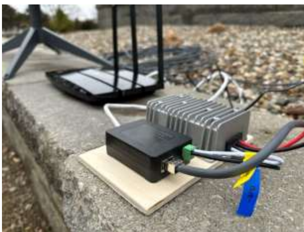
Рис. 3.1 Блок живлення 12V
