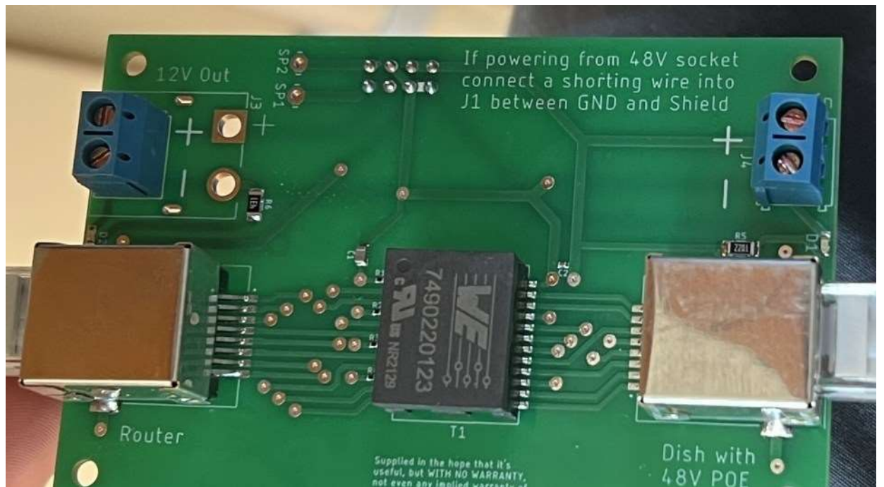
Рис. 3.3 Лицьова частина інжектора
