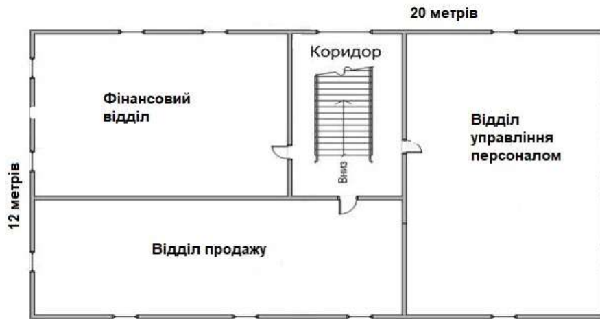
Рис.2.2. План будівлі 2 поверху
