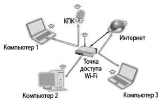
Рис.1.2. Схема роботи Wi-Fi маршрутизатора
