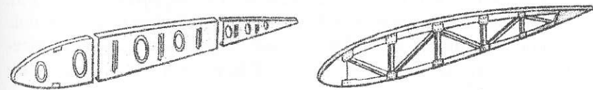
Рис. 5.12. Типові нервюри: а – балкові; б – фермові
