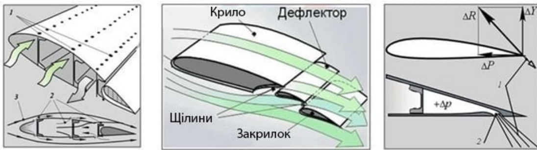
Рис. 2.3 Енергетичні засоби збільшення підйомної сили крила
