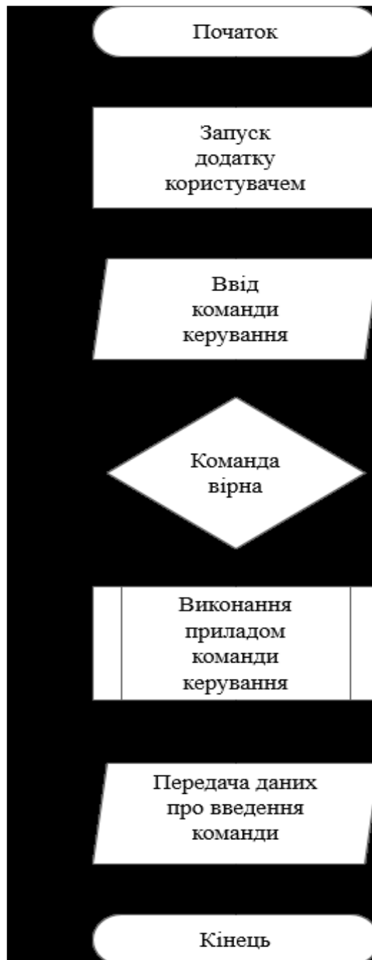
Рис. 3.6 - Загальна схема реалізації алгоритму дистанційного керування ЗВП
