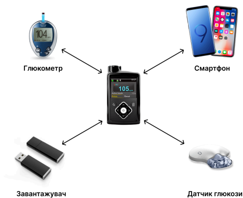
Рис. 2.3. Топологія BLE Connect
