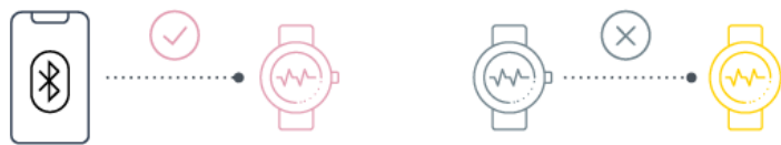
Рис. 2.2. Асиметрична архітектура BLE
