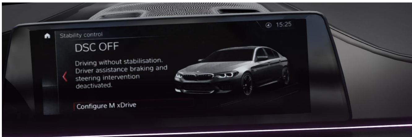
Рис. 3.6. Приборна панель автомобіля з відключеними системами допомоги.
