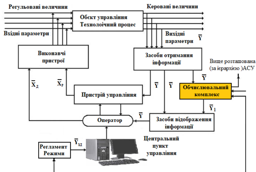
Рис.1.2. Структура автоматизованої системи управління технологічним процесом з обчислювальним комплексом, що виконують функції управління в режимі “порадника” .
