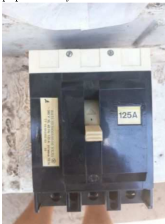
Рисунок 1.9 – Фотографія вимикача ВА-51-33
