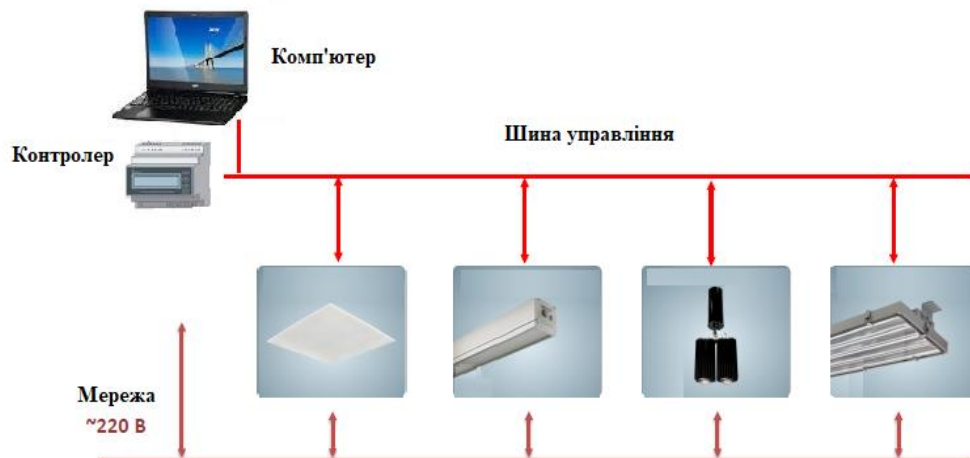
Рис. 4.3 Безпосереднє цифрове керування освітленням
