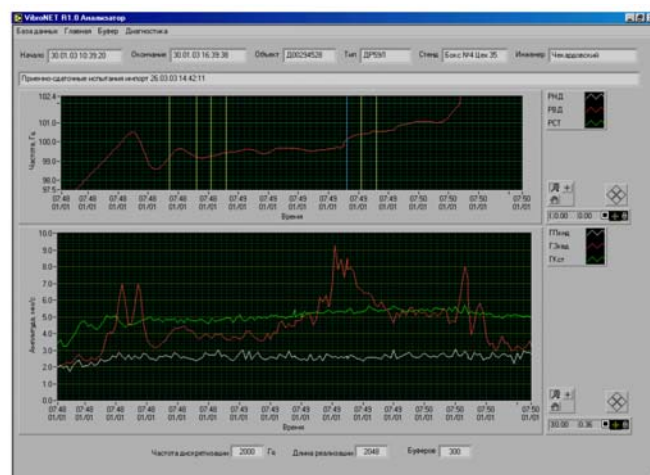
Рисунок 2.8 - Амплітуда та частота вібравантажень (циклограма випробувань двигуна P-25-300, пр.17/47)
