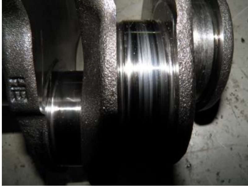
Рисунок 1.2 – Знос шийок колінчастого валу авіаційного ДВЗ
