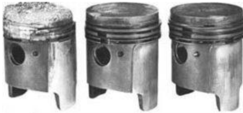
Рисунок 1.1 – Знос верхньої частини ЦПГ авіаційного ДВС
