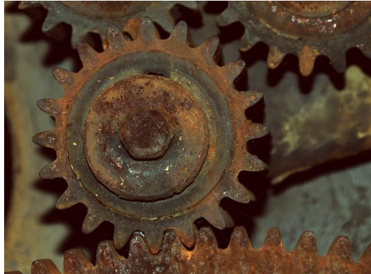
Рисунок 1.4 – Пошкодження деталей в наслідок електрохімічної корозії
